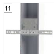
Elementy wzmacniające konstrukcję ościeżnicy
